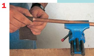
**1. Nettoyer parfaitement les surfaces à souder (extérieur du tube et intérieur du raccord) avec de la toile émeri fine...**
